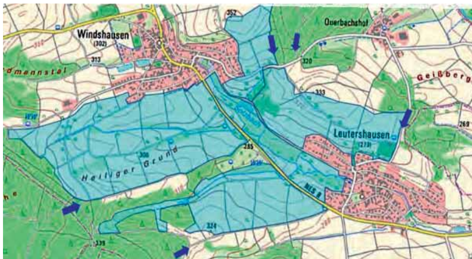
Wassereinzugsgebiet des Solzbachs vor Leutershausen. Die blauen Pfeile verweisen auf Flurwege und Straßen die zusätzlich aus den angrenzenden Waldgebieten viel Wasser zuleiten könnten.
