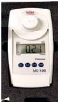
Bild links: Messgerät zur Kontrolle der Chlorkonzentration im Trinkwasser
